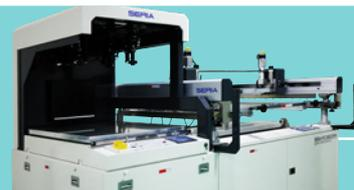
带 CCD 摄像机半自动印刷机
